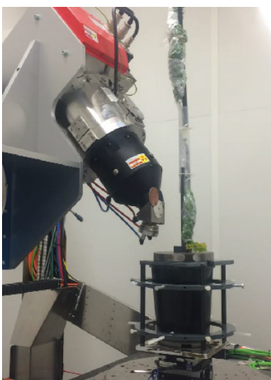
↑ Ein junger Baum wird an einem stabilen Rahmen befestigt und unter einen Röntgen-Mikrotomografie-Scanner platziert.
