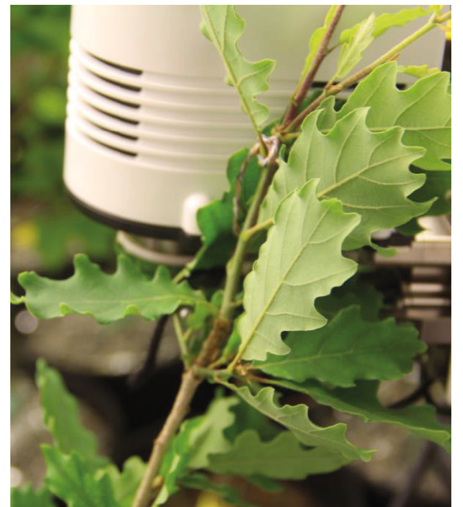
↑ Die stomatäre Leitfähigkeit des Blattes einer Flaumeiche wird mithilfe eines Gasaustauschgeräts gemessen.
